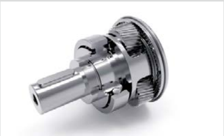
输出行星架采用一体式（双支撑）的结构设计，前后轴承大跨距分布于箱体内部，形成稳定的一体式结构，以确保较高的扭转刚性和精度
