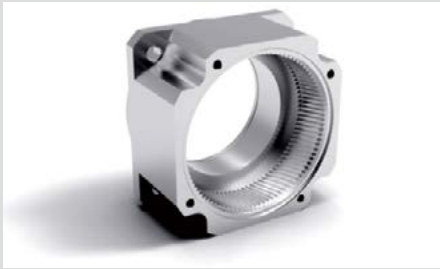
齿圈与输出壳体采用一体化设计，采用优质钢材，经热锻成形，从而获得较高的辅料密度。一体化设计能保证所有几何尺寸一次性加工完成，与其它内嵌式、夹装式等结构相比具有更高的精度和强度
