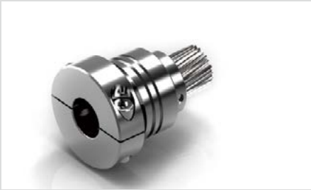
输入轴与制紧装置采用一体化设计，双螺栓对称分布，达到动平衡的同时，通过双螺栓的强力锁死，有效防止电机轴传动打滑，实现高精度零背隙的动力传送。
